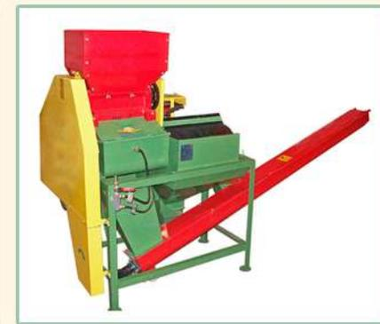
Beneficio Ecológico para café cereza maduro con tecnología de despulpado horizontal y una criba (zaranda) para separar los granos despulpados de los no despulpados. Incluye un desmucilagador que remueve mecánicamente el mucílago con poca agua, entregando el café pergamino listo para el proceso de secado.
